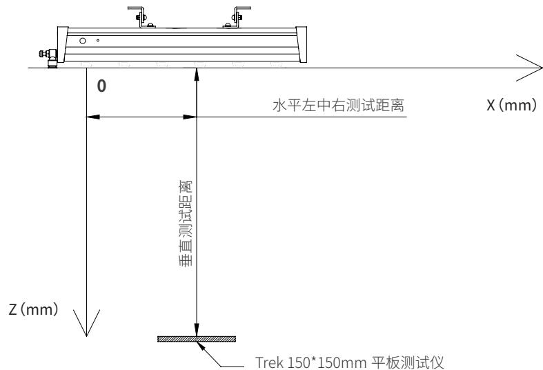
注：两端测试时，平板边缘与离子棒左右两端首、尾电极针对齐
