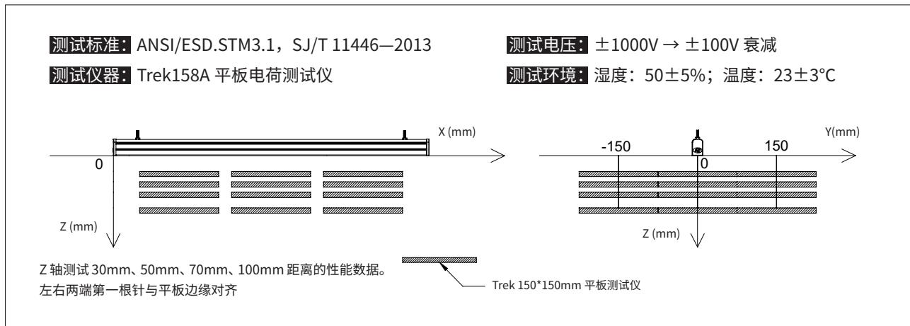
消电数据图如下：注：离子棒长度：550mm，高压线长度：6m
