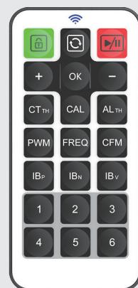
当平板检测仪或被消电物体表面正电压较大时，先按 PWM，再按 -；当平板检测仪或被消电物体表面负电压较大时，先按 PWM，再按 +；直至将平衡电压调节到理想状态。
