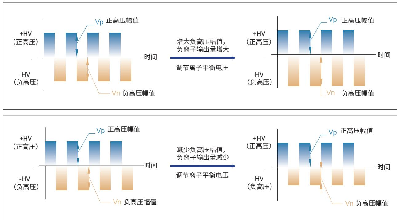
◆ 正、负离子输出频率可调，可适用于不同的消电距离，实现较快的消电速度。
